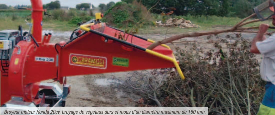
Broyeur moteur Honda 20cv, broyage de végétaux durs et mous d'un diamètre maximum de 150 mm.
